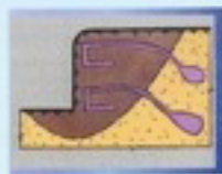
Крепление подпорных стенок
