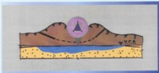
Прокладка магистральных трубопроводов в обводненных грунтах
